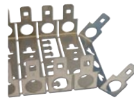
LSA 2/10-MW10-25/22 (24 01 10) Montagewanne 10x 10DA (modular): Raster: 25 mm / Tiefe: 22 mm beliebig trennbar, bis zu einer Größe von 78 Anschlussmodulen lieferbar.
